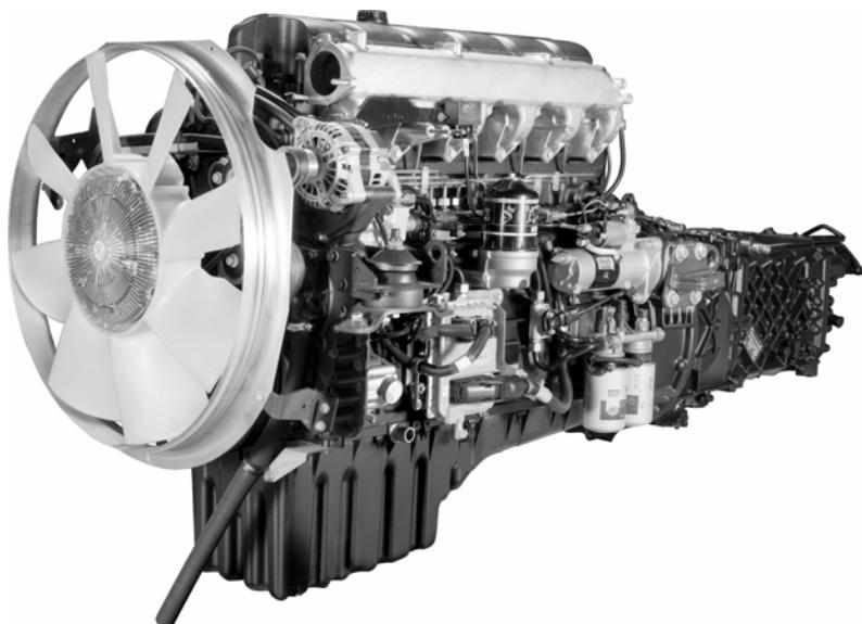
Рис. 1. Силовой агрегат ЯМЗ-6501 – вид слева
